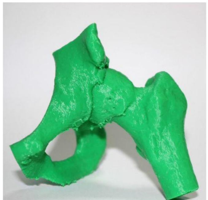
Figura 1: Modelo final impreso en 3D de una articulación de la cadera izquierda.
